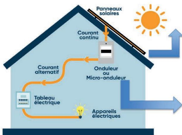
Les panneaux solaires sont des dispositifs énergétiques mesurant en moyenne 1m70 de hauteur sur 1m de largeur. Ils sont composés de cellules de silicium, aussi appelées cellules photovoltaïques, capables de capter la lumière du soleil puis de la transformer en électricité.
