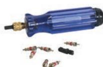
Idéal pour le tirage au vide, la charge et la récupération. Permet de retirer les valves Schrader sous pression. Réduit considérablement le temps de tirage au vide et de charge de l'installation. Connexion extra en 1/4" SAE permet de connecter un vacuomètre tel que VGW-760 pour un contrôle parfait du tirage au vide.
