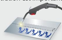
Déplacement par balayage, pour une soudure renforcée.
