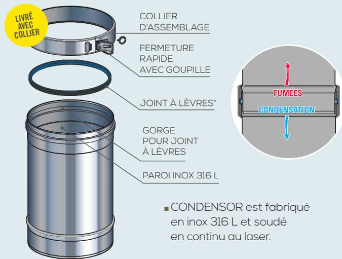
■ CONDENSOR est fabriqué en inox 316 L et soudé en continu au laser.
