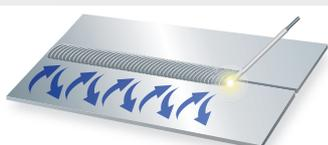
Déplacement par balayage, maximum 6 fois la largeur de l'électrode. (soudure renforcée)
