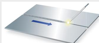
Déplacement rectiligne, cordon 2 à 3 fois plus large que le diamètre de l'électrode.
