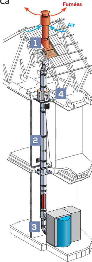
CONDUIT VERTICAL EXTÉRIEUR AVEC TRAVERSÉE DE MUR CHAUDIÈRE À GRANULÉS
