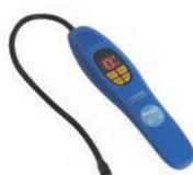
Doté d'un capteur de type semi-conducteur contrôlé par microprocesseur, LT-100-PRO2 est d'une grande sensibilité < 3gr/an pour la détection de fuite de gaz HFC, HFO, HC et azote hydrogéné (N2/H2). Mode de détection automatique ou manuel avec réglage de la sensibilité (3 niveaux)
