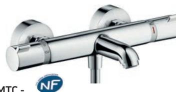
Longueur 178 mm - entraxe: 150 mm ± 12 mm - robinet d'arrêt/inverseur, cartouche thermostatique SMTC - butée de confort à 40° C
