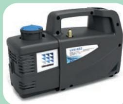
Compacte, ultra légère (moins de 8kg !) Pour des flexibles standards 1/4" SAE et à gros débits 3/8" SAE. Moteur «DC brushless» plus puissant et léger, à durée de vie prolongée. Moteur basse vitesse qui prévient d'une usure prématurée de la pompe, Electrovanne incluse et vacuomètre intégré sur le dessus de la pompe pour une lecture plus aisée.
