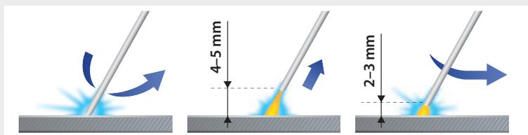
En phase de soudure gardez l'électrode à 2 mm de la pièce à souder, déplacez l'électrode soit de façon droite soit en balayant la soudure.
