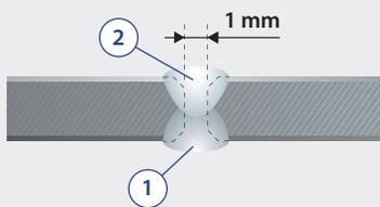
■ Pour souder des grandes pièces (>6 m), réalisez un chanfrein à la lime ou à la meuleuse. Pré-assemblez les pièces par quelques points de soudure tous les 10 cm, puis réalisez les différentes passes selon le schéma ci contre.
